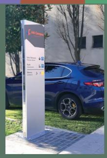
Le superfici informative in alluminio scatolato verniciato sp. 1,5 mm sono dotate di feritoie a passo modulare per l'aggancio alla struttura portante provvista di profili in acciaio inox con apposita cremagliera. Una base di fissaggio al suolo rende solidale la struttura al plinto in calcestruzzo.
