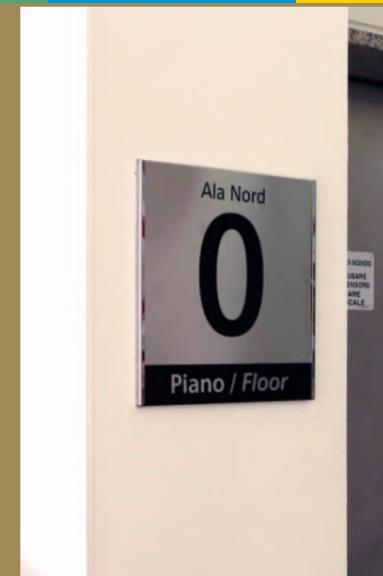
I pannelli intercambiabili a superficie piana sono in acciaio inox spazzolato AISI 304 sp. 0,6 mm. Sagomato ai lati, è provvisto di profili verticali in acciaio inox lucido AISI 430 sp. 0,8 mm. La grafica viene realizzata mediante applicazione di testi in pellicola vinilica adesiva. E' previsto l'utilizzo di uno speciale supporto per realizzare segnali bifacciali a bandiera.
