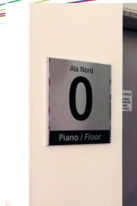
I pannelli intercambiabili a superficie piana sono in acciaio inox spazzolato AISI 304 sp. 0,6 mm. Sagomato ai lati, è provvisto di profili verticali in acciaio inox lucido AISI 430 sp. 0,8 mm. La grafica viene realizzata mediante applicazione di testi in pellicola vinilica adesiva.
